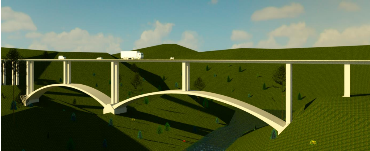
Abbildung 5.5.2: Gerenderte Variante mit Doppelbogen einer Brücke
